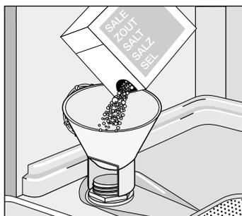
5. Revissez soigneusement et hermétiquement le bouchon en vous assurant qu'il n'y ait pas de sel sur le filetage et sur le joint.
