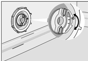
Le réglage est effectué en usine sur la position 2.
