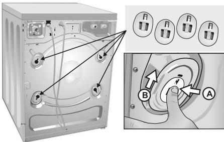
8. Placer le cache de plastique sur les trous précédemment occupés par les jeux de boulons de transport. Pousser sur la languette (A) et faire coulisser le cache vers la petite fente (B).
