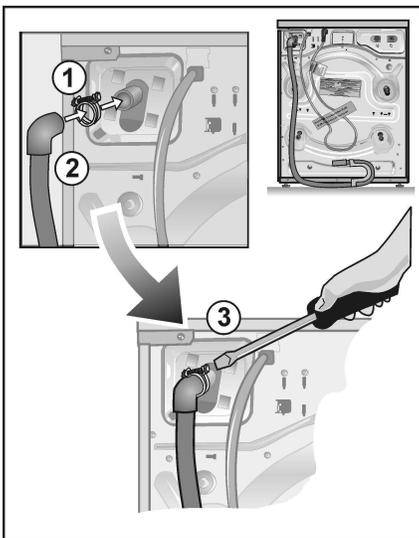
2. Fixez le tuyau de vidange contre le raccord à cet effet au dos de l'appareil; positionnez la bride du flexible à approx. 3/8 pouces (9 mm) de l'extrémité du flexible.
