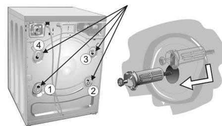
3. Desserrer les jeux de boulons en utilisant la clé polygonale de 1/2 po fournie, ou une clé à douille de 1/2 po. Les desserrer jusqu'à ce qu'ils tournent librement.
