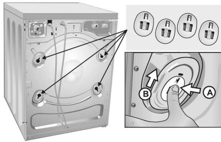
8. Coloque la cubierta de plástico sobre el orificio que ocupan los conjuntos de pernos de transporte. Empuje la lengüeta hacia adentro (A) y deslice la cubierta hacia la ranura pequeña (B).
