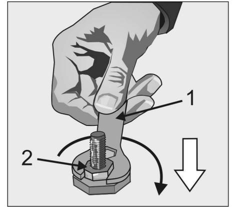
(la figure ci-dessus montre le pied de mise à niveau du lave-linge démonté de l'appareil pour plus de clarté).
