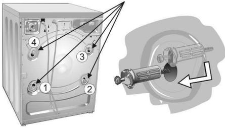
3. Afloje los conjuntos de pernos usando el extremo cerrado de la llave de 1/2 pulg. incluida o una llave de cubo de 1/2 pulg. Aflojelos hasta que puedan moverse libremente.
