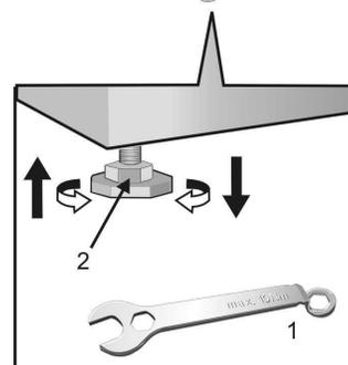
5. Gire la pata hacia la derecha para extenderla. Continúe girándola hasta que la pata quede bien ajustada contra el piso. Vuelva a empujar la esquina de la lavadora hacia abajo. Cuando la esquina de la lavadora no se mueva hacia abajo, trabe la pata en su lugar apretando la tuerca de retención de nuevo hacia arriba contra la parte inferior de la lavadora.
