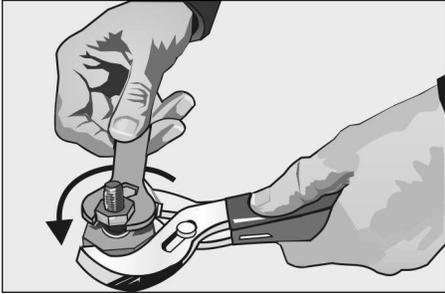
7. Maintenir la partie caoutchoutée inférieure du pied du lave-linge à l'aide d'une clé de 36 mm (1 pouce 1/2) ou d'une paire de pinces à joint coulissant pour l'empêcher de pivoter.
