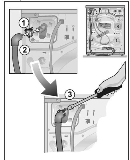
2. Acoplar la mangera de deagüe en el conexión de desagüe en la parte posterior del aparato. Colocar la abrazadera a aprox. 9 mm de distancia del extremo de la manguera.
