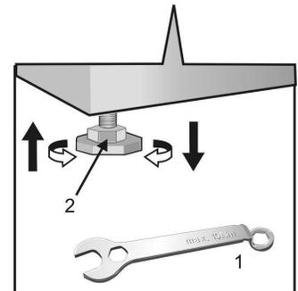
5. Faire tourner le pied dans le sens des aiguilles d'une montre pour l'allonger. Continuer de tourner jusqu'à ce que le pied soit bien plaqué contre le sol. Appuyer de nouveau sur l'angle du lave-linge. Lorsque l'angle du lave-linge ne s'affaisse plus, bloquer le pied en serrant de nouveau le contre-écrou contre le fond du lave-linge.
