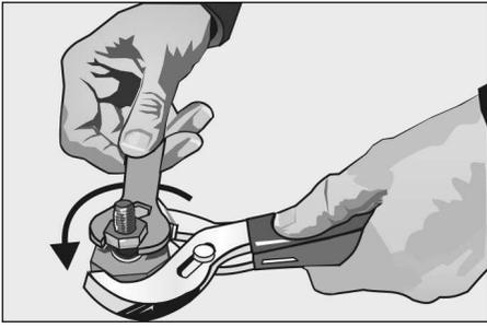
7. Sostenga la parte de hule inferior que se encuentra en la pata de la lavadora con una llave de 36 mm (1 1/2 pulg.) o una pinza ajustable para evitar que gire.
