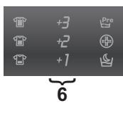
Die Anzeige zeigt die Anzahl der ausgewählten Zusatzspülgänge an. Diese können je nach Programm über die entsprechende Taste angepasst werden.
