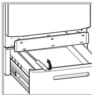
1. rimuovere il pannello di copertura sul lato anteriore della macchina con l'ausilio di un giravite (vedi figura);
