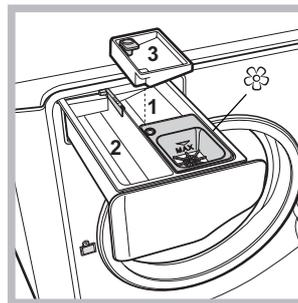
1. *vaschetta per il prelavaggio*: usare detersivo in polvere. (Prima di versare il detersivo verificare che non sia inserita la vaschetta aggiuntiva 3).
