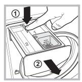
Para extraer el contenedor, presione la palanca (1) y tire hacia afuera (2) (ver la figura).
