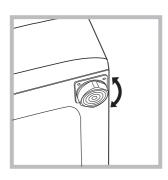
2. Compense as irregularidades desatarraxando ou atarraxando os pés até que a máquina esteja nivelada horizontalmente (não deve ter uma inclinação superior aos 2 graus).
