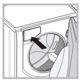
Het wasmiddelbakje bevindt zich aan de binnenkant van de automaat en verschijnt als u de deur opent. Voor de dosering van wasmiddelen zie het hoofdstuk "Wasmiddelen en wasgoed".
