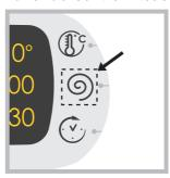
Para modificar las programaciones presionar levemente en el icono dentro del área sensible (touch control) como se indica en la figura.
