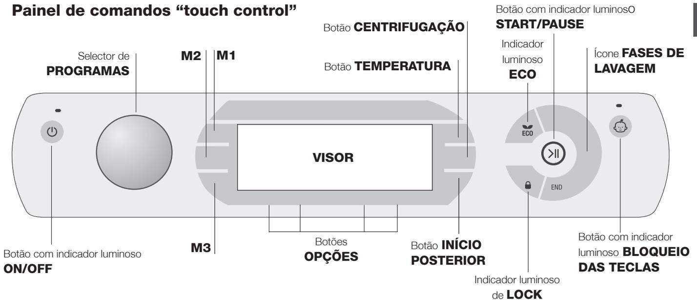
Botão com indicador luminoso **ON/OFF**: carregue brevemente no botão para ligar ou desligar a máquina. O indicador luminoso verde indica que a máquina está ligada. Para desligar a máquina de lavar roupa durante a lavagem, é necessário manter pressionado o botão por mais tempo, aproximadamente 3 segundos; uma pressão breve ou acidental não permitirá o desligamento da máquina. O desligamento da máquina durante uma lavagem em curso anula a própria lavagem.
