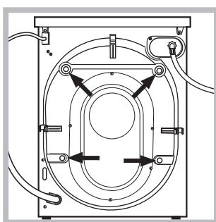
3. Odstraňte 4 šrouby chránící před poškozením během přepravy a gumovou podložku s příslušnou rozpěrkou, které se nacházejí v zadní části (viz obrázek).
