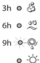
Con el transcurrir del tiempo se visualizará el retraso residual con el centelleo de la luz testigo correspondiente:
