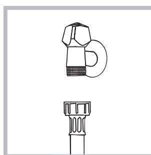
1. Reliez le tuyau d'alimentation en le vissant à un robinet d'eau froide à embout fileté 3/4 gaz (*voir figure*). Faire couler l'eau jusqu'à ce qu'elle soit limpide et sans impuretés avant de raccorder.
