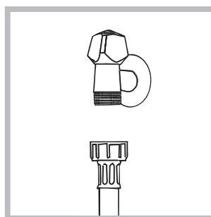
1. Schrauben Sie den Wasserschlauch an einen Kaltwasserhahn mit 3/4-GAS-Gewindeanschluss an (siehe Abb.). Lassen Sie das Wasser vor dem Anschluss so lange auslaufen, bis klares Wasser austritt.
