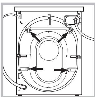
3. Verwijder de **4** schroeven die het apparaat beschermen tijdens het vervoer en de rubberen ring met bijbehorende afstandsleider die zich aan de achterkant bevinden (*zie afbeelding*).
