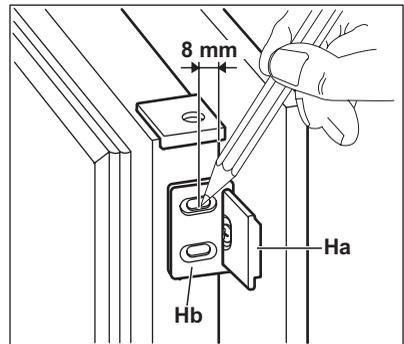
11. Retirez les supports et repérez une distance de 8 mm à partir de l'arête extérieure de la porte où le clou doit être posé (K).
