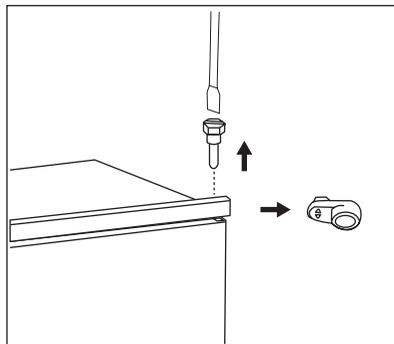
4. Lösen Sie den unteren Bolzen mit einem Schlüssel.
