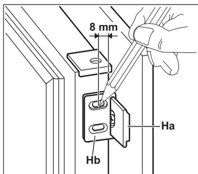
11. Nehmen Sie die Halterungen wieder ab. Markieren Sie 8 mm von der Außenkante die Stelle, an der der Nagel (K) eingeschlagen werden muss.
