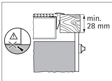
**i** Wenn Sie einen Schutzkasten (zusätzliches Zubehör) verwenden, ist der Bodenschutz direkt unter dem Gerät nicht erforderlich.
