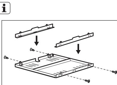
Si vous utilisez une enceinte de protection (accessoire en option<sup>1)</sup>), l'espace de circulation d'air de 2 mm et le fond de protection installé directement sous l'appareil ne sont plus nécessaires.
