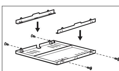
Als u een beveiligingsdoos gebruikt (extra toebehoren <sup>1)</sup>), dan is de voorste ventilatieruimte van 2 mm en de beschermmat onder het apparaat niet nodig.
