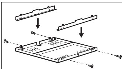
Falls Sie einen Schutzboden verwenden (zusätzliches Zubehör<sup>1)</sup>, ist die Einhaltung des vorderen Belüftungsabstands von 2 mm unter dem Gerät nicht nötig. Wenn Sie das Gerät über einem Backofen einsetzen, können Sie den Schutzboden nicht verwenden.
