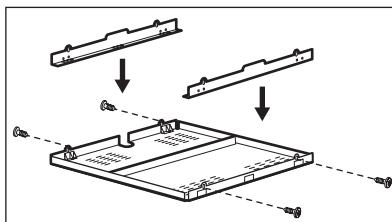
Falls Sie einen Schutzboden verwenden (zusätzliches Zubehör 1), ist der Bodenschutz direkt unter dem Gerät nicht erforderlich.
