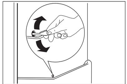
Bei normalem Betrieb wird Reif bei jedem Anhalten des Kompressors automatisch vom Verdampfer des Kühlschranks entfernt. Das Tauwasser sammelt sich in einer Auffangrinne und läuft durch eine Abflussöffnung in einen speziellen Behälter an der Rückseite des Geräts über dem Kompressor, wo es verdampft. Reinigen Sie deshalb regelmäßig die Abflussöffnung in der Mitte der Auffangrinne an der Kühlraumrückwand, damit das Tauwasser nicht überfließt und auf
