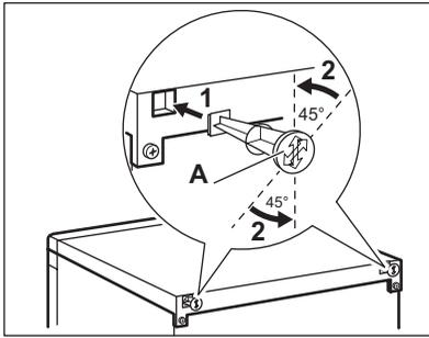
Im Beutel mit Dokumentationsunterlagen befinden sich zwei Distanzstücke, die wie in der Abbildung gezeigt, angebracht werden müssen.
