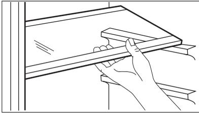
Die Wände des Kühlschranks sind mit einer Reihe von Führungsschienen ausgestattet, die verschiedene Möglichkeiten für das Einsetzen der Ablagen bieten.
