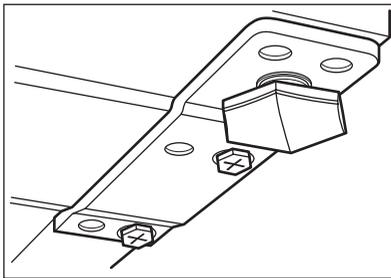
Bei der Aufstellung des Geräts ist dieses waagrecht auszurichten. Dies lässt sich mit zwei Schraubfüßen am vorderen Sockel des Gerätes erreichen.
