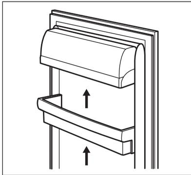
Die Türeinsätze können in unterschiedlicher Höhe positioniert werden, womit das Lagern verschieden großer Lebensmittelpackungen ermöglicht wird. Gehen Sie dazu wie folgt vor: Ziehen Sie die Ablage langsam in Pfeilrichtung, bis sie sich herausheben lässt, und setzen Sie sie dann nach Wunsch wieder ein.
