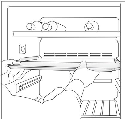
Le fond intermédiaire peut être ajusté d'une position vers le haut ou le bas. Pour cela, tirer de la paroi arrière et soulever côté porte.
