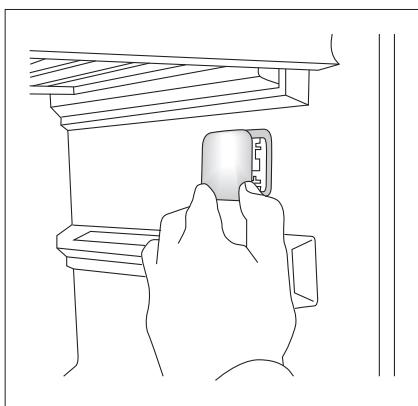
Décliquer l'éclairage par DEL. Desserrer le cavalier de l'éclairage. Remettre le nouvel éclairage dans le sens contraire.
