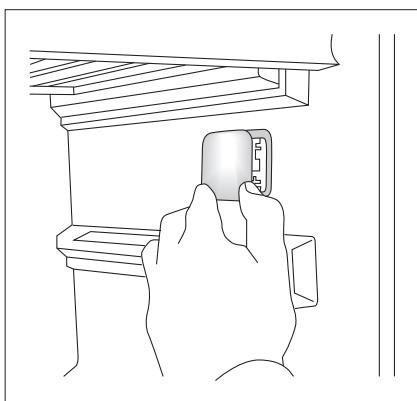
Soltar o LED de iluminação. Soltar a ficha de ligação ao LED. A colocação do novo LED processa-se pela ordem inversa.
