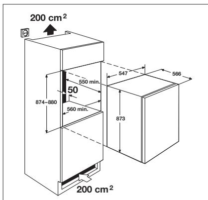
Compruebe después de empotrar el aparato, sobre todo si ha cambiado el tope de la puerta, si la junta de estanqueidad de la puerta hermetiza correctamente en todo el perímetro. Una junta que hermetice mal puede provocar un aumento de la condensación y con ello un mayor consumo energético (véase también el aparato "Ayuda en caso de averías").
