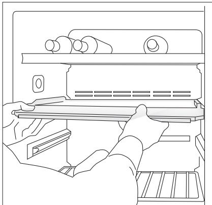
Der Zwischenboden kann 1 Position nach oben oder nach unten verstellt werden.
