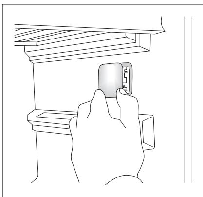
Pulse para desconectar el diodo de iluminación. Suelte la conexión por enchufe del diodo. Inserte el nuevo diodo de iluminación en orden inverso.
