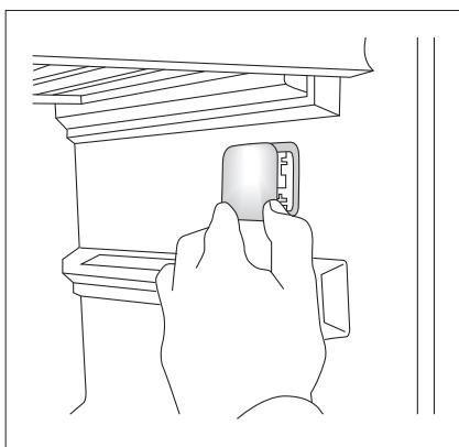
Klicken Sie die LED-Beleuchtung aus. Lösen Sie die Steckverbindung zur LED-Beleuchtung. Die neue LED-Beleuchtung bitte in umgekehrter Reihenfolge einsetzen.
