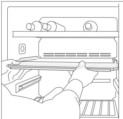
La bandeja se puede mover 1 posición hacia arriba o hacia abajo. Para ello, tire desde la pared trasera hacia delante y levante por el lado de la puerta.
