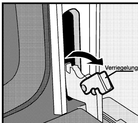
2. Öffnen Sie an beiden Seiten der Türe die an den Tüangeln befindlichen Riegel bis diese die unterstützenden Zapfen berühren.
