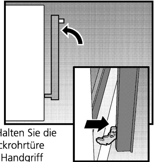
4. Halten Sie die Backrohrtüre am Handgriff leicht fest, schließen Sie es behutsam, ziehen Sie nach oben und bis eine wenige Zentimeter große Öffnung verbleibt. Nun können Sie die Angeln aus dem Angelgehäuse herausnehmen.
