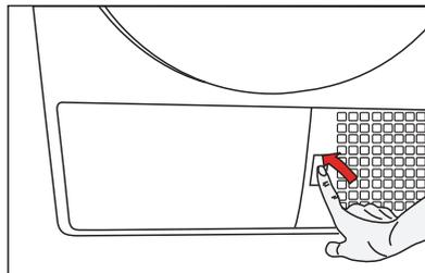
2. Entfernen Sie die Filterschubladenabdeckung durch Drehen in Pfeilrichtung.
