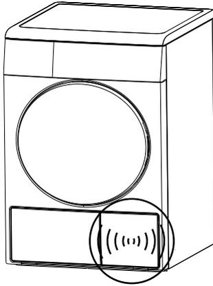
**i** Im Betrieb gesammeltes Wasser wird in den Wassertank gepumpt. In dieser Phase sind Arbeitsgeräusche der Pumpe völlig normal.
