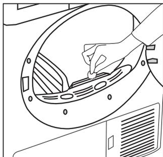
Ihr Gerät arbeitet mit Feuchtigkeitssensoren, um den Trocknungsgrad der Wäsche zu erkennen.
