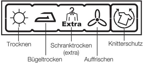
Der Fortschritt eines laufenden Programms wird durch eine Reihe von Symbolen angezeigt.
