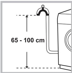
Verbindt de afvoerbuiss, zonder hem te buigen, aan een afvoerleiding of aan een afvoer in de muur tussen de 65 en 100 cm van de grond af.
