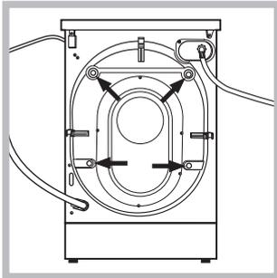
2. Verwijder de 4 beschermerschroeven voor het transport en de bijbehorende afstandslider die zich aan de achterkant bevinden (zie afbeelding).
