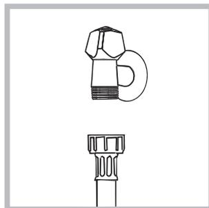
2. Sluit de toevoerbuis aan op de koudwaterkraan met een mondstuk met schroefdraad van 3/4 gas (zie afbeelding).
