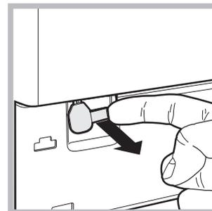
4. trek het lipje dat wordt aangegeven in de afbeelding naar voren totdat het plastic bandje loskomt; trek hem daarna naar beneden totdat u klik hoort, wat aangeeft dat de deur is geopend.
