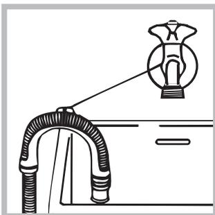
Als alternatief kunt u de afvoerbuiss aan de rand van een wasbak of badkuip hangen nadat u hem met de steun aan de kraan heeft bevestigd (zie afbeelding). Het uiteinde van de afvoerbuiss mag nooit onder water liggen.
