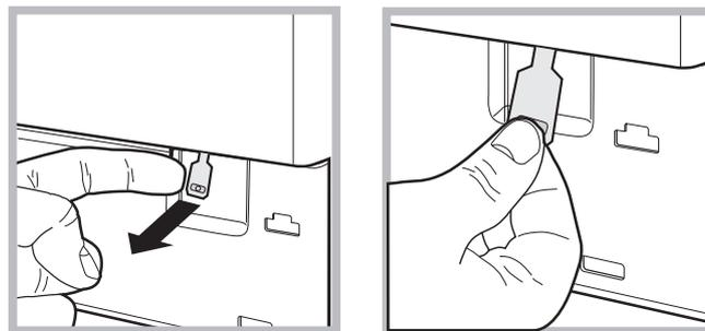
4. pociągnąć na zewnątrz klapkę wskazaną na rysunku, aż do wyzwolenia się z zacisku plastikowego zaczepu; następnie pociągnąć go w dół i równocześnie otworzyć drzwiczki.
