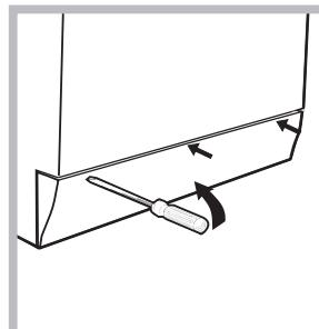
3. Nehmen Sie die Abdeckung (befindlich an der Gerätefront) mit Hilfe eines Schraubenziehers ab (siehe Abbildung).
