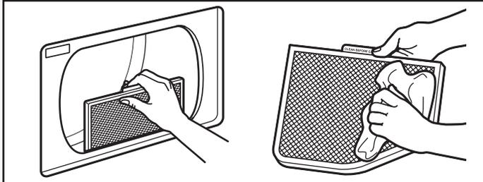
Nettoyer le filtre à charpie avant chaque charge. Enlever le filtre à charpie en le tirant tout droit vers le haut. Enlever la charpie du filtre en la roulant avec les doigts. Ne pas rincer ni laver le filtre pour enlever la charpie. Remettre le filtre à charpie fermement en place.
