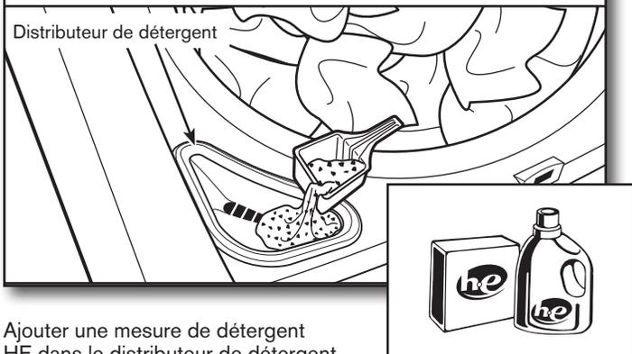
Ajouter une mesure de détergent HE dans le distributeur de détergent.
