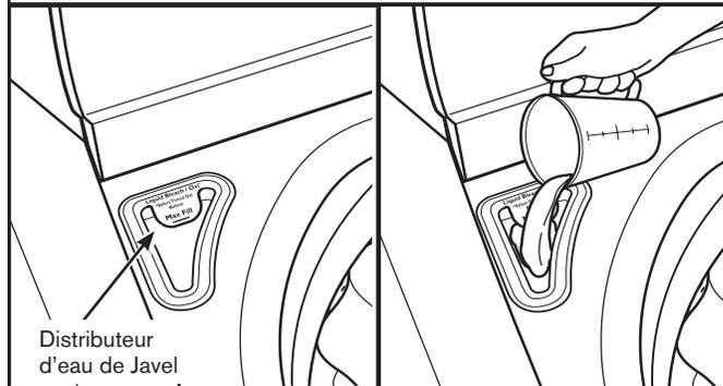
Ne pas remplir excessivement le distributeur, diluer le produit ni utiliser plus de 3/4 de tasse (180 mL). Ne pas utiliser d'agent de blanchiment sans danger pour les couleurs ni de produit Oxi avec un programme utilisant de l'eau de Javel. Afin d'éliminer le maximum de saleté et de taches, utiliser le distributeur d'eau de Javel pour de l'eau de Javel, l'agent de blanchiment sans danger pour les couleurs ou les activateurs de lessive Oxi.
