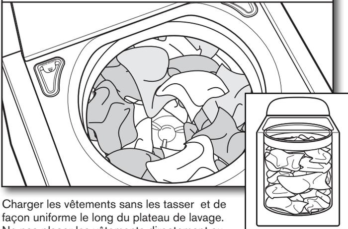
Charger les vêtements sans les tasser et de façon uniforme le long du plateau de lavage. Ne pas placer les vêtements directement au centre du plateau de lavage – celui-ci doit être visible. Essayer de mélanger différents types d'articles pour réduire l'emmêlement.
