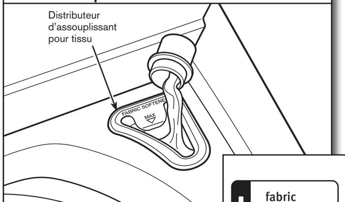
Verser une mesure d'assouplissant pour tissu liquide dans le distributeur – toujours suivre les instructions du fabricant concernant la dose d'assouplissant pour tissu à utiliser en fonction de la taille de la charge. Sélectionner ensuite l'option Fabric Softener (Assouplissant pour tissu).
