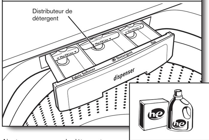
Ajouter une mesure de détergent HE dans le distributeur de détergent. La capacité de ce tiroir est de 3 oz (89 mL). Ne pas faire remplir excessivement le tiroir – le fait d'ajouter trop de détergent peut entraîner sa distribution prématurée dans la laveuse.
