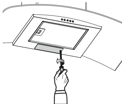
3. Retirer le protège-ampoule et le mettre de côté avec la vis.
