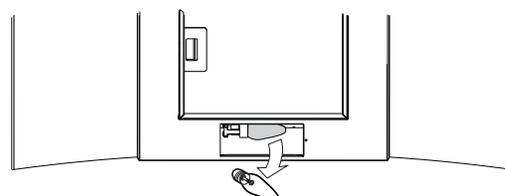
5. Réinstaller le protège-ampoule et la vis.
